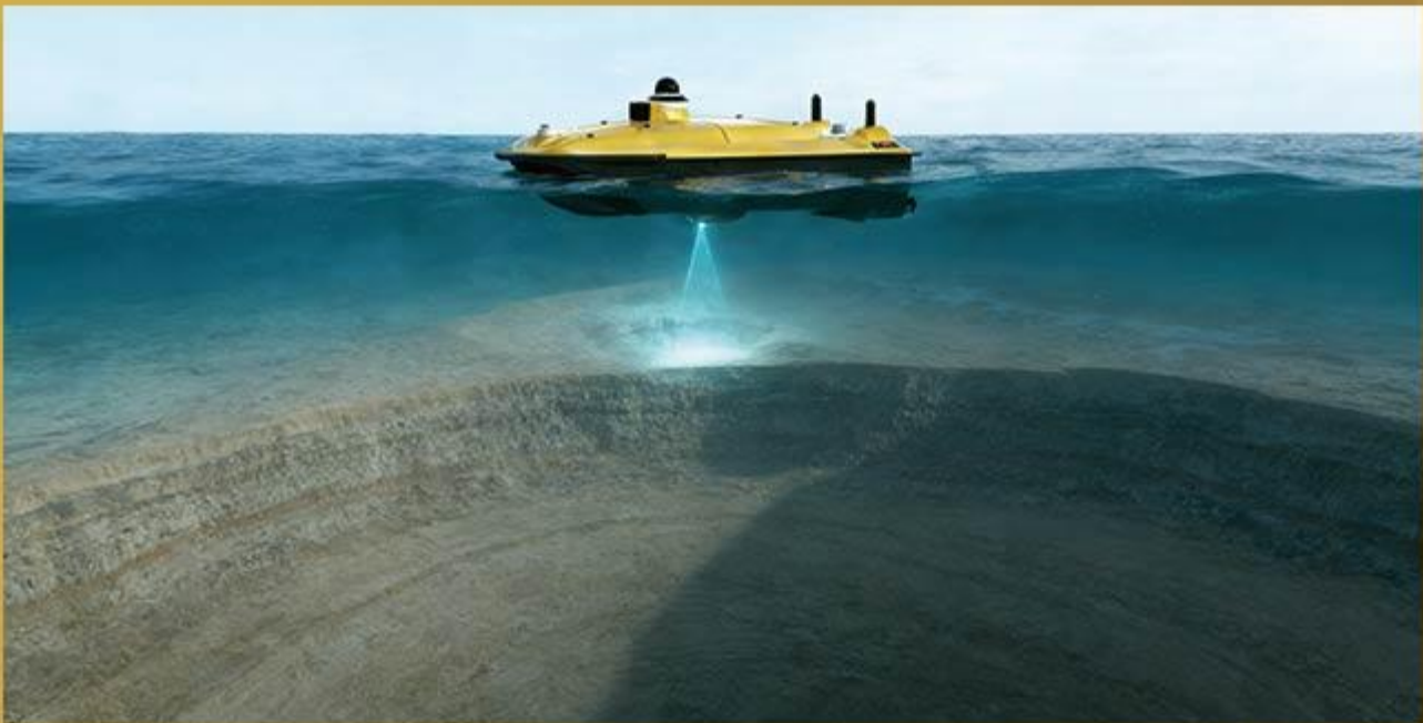
Medição de profundidade de água
